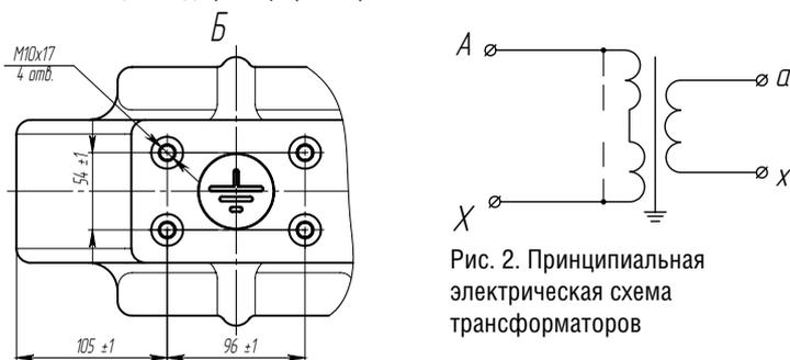
Рис. 2. Принципиальная электрическая схема трансформаторов
